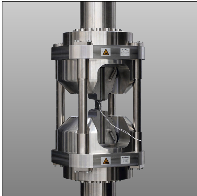
Hydraulischer Keil-Probenhalter BOW-600 mit seitlicher Führung
