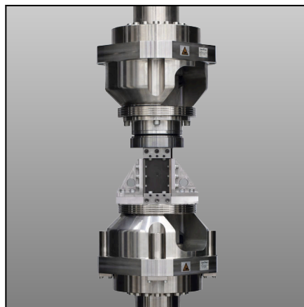
BOW-Probenhalter mit Druckvorrichtung und CAI-Prüfvorrichtung
