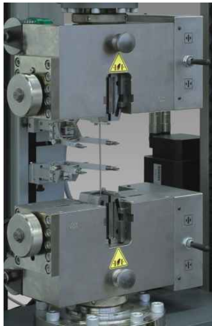
Рис.1: Испытание тонкой проволоки на растяжение с датчиком продольной деформации Макро
