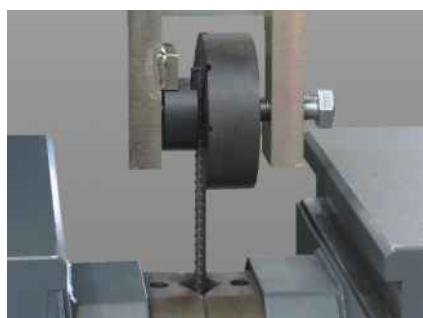
Рис.2: Испытание решетчатой опоры на срез
