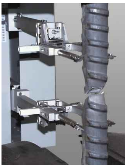
Рис.1: Испытание рифленой арматурной стали на растяжение с датчиком продольной деформации Макго
