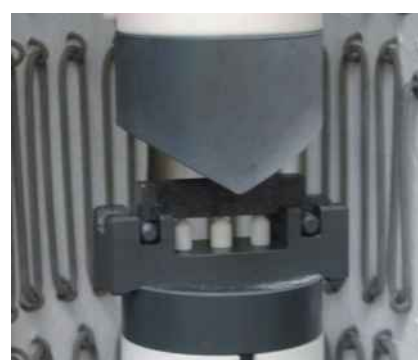
Рис.3: Испытание на изгиб в высокотемпературной печи
