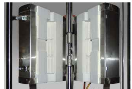
Рис.3: Открытая печь с термоэлементами
