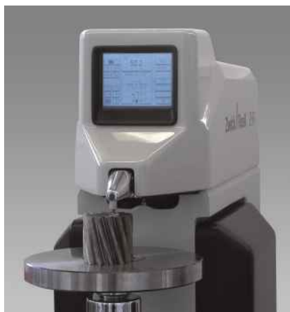
Рис.1: Zwick/ZHR 8150SK для серийных испытаний небольших партий
