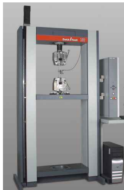
Рис.2: Испытательная машина Zwick 1455 с блоком электроники testControl после модернизации
