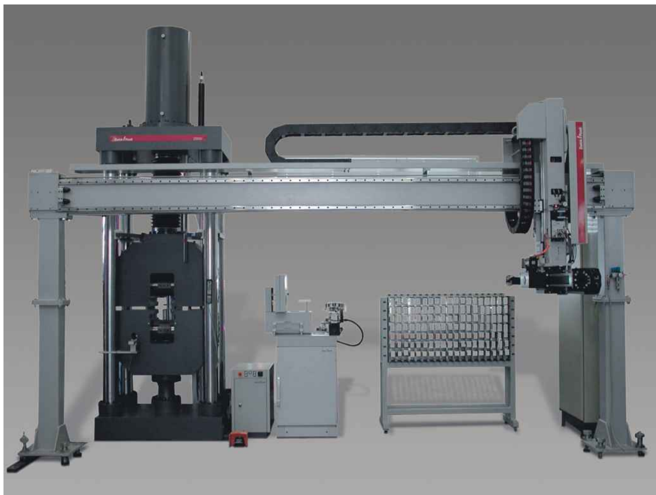
Рис.1: Автоматизированное испытание толстолистового проката на растяжение (система roboTest B)
