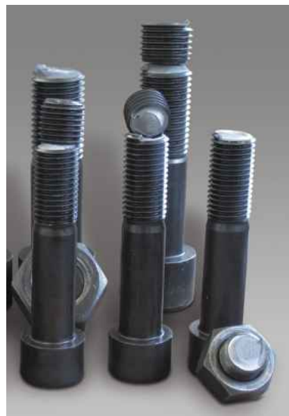
Рис.2: Болты после разрушения
