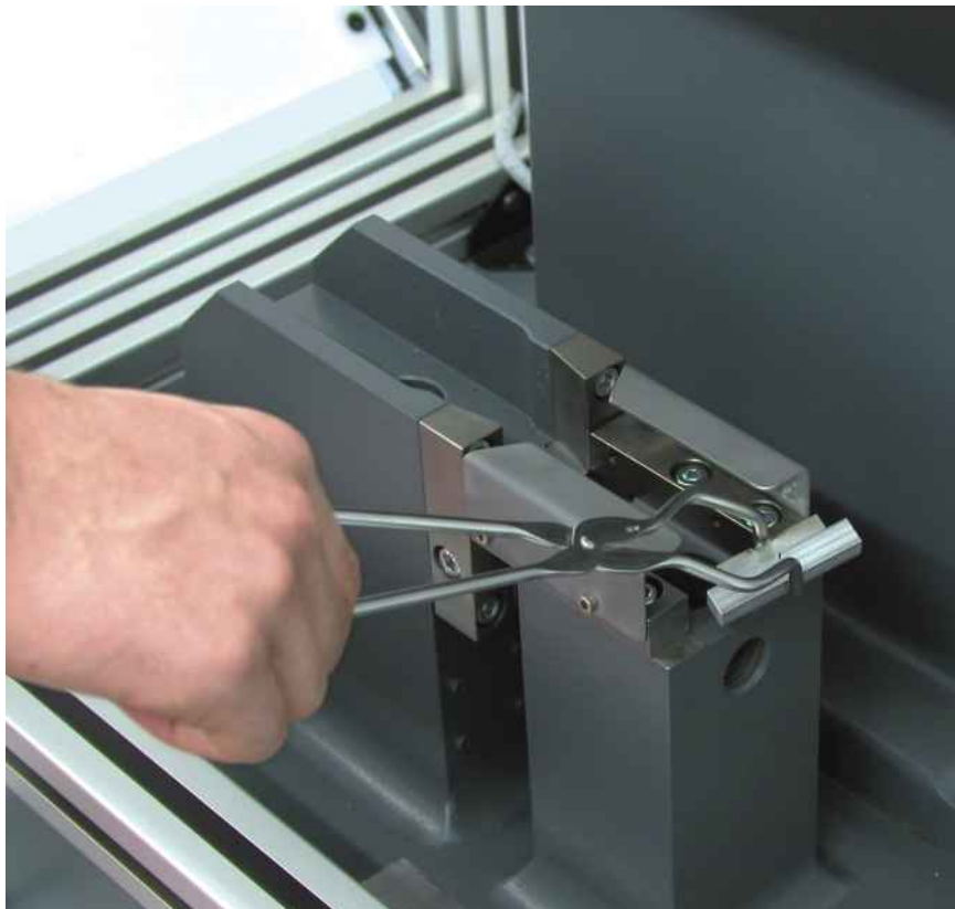
Рис.1: Маятниковый копер RKP 450 (сегмент рисунка: упоры)
