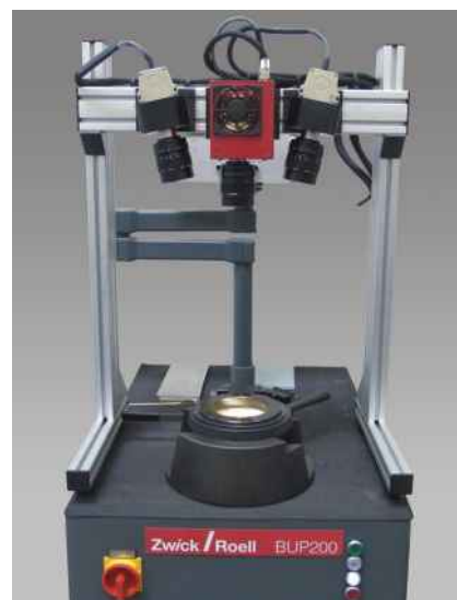
Рис.3: BUP 200 с модулем анализа кривой пограничной деформации (FLC)
