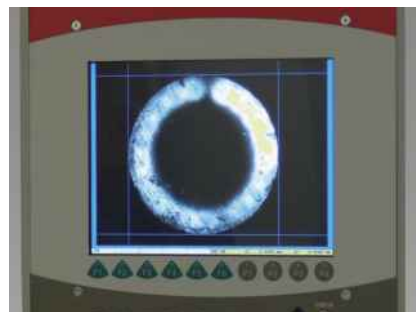
Рис.3: Темнопольный метод освещения с опцией освещения кольцевым светом
