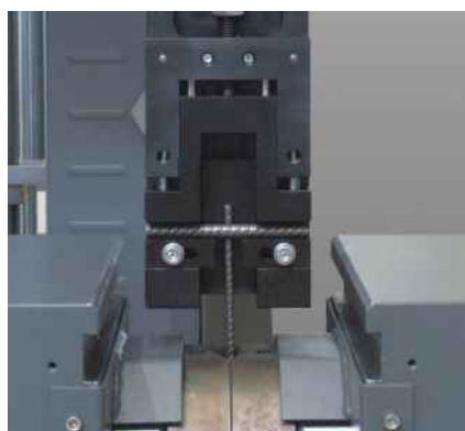
Рис.1: Испытание сварного шва, T-образное соединение
