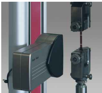
Рис.1: Посредством выбора поля зрения датчик videoXtens адаптируется к соответствующей задаче испытания
