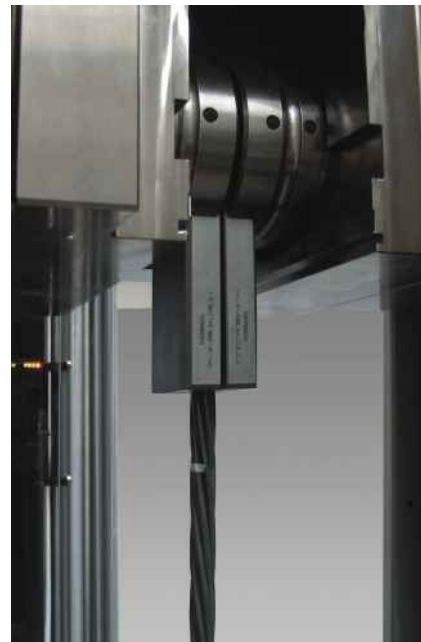
Рис.2: Зажимное приспособление для арматурных прядей
