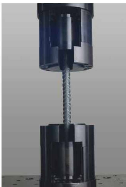
Рис.2: Захваты и заливка образца из рифленой арматурной стали
