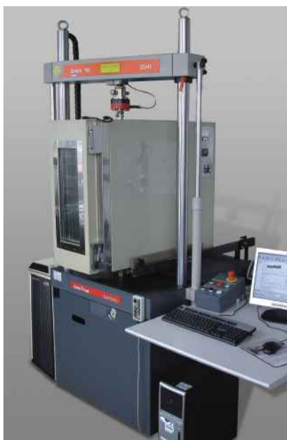
Рис.1: Сервогидравлическая испытательная машина Zwick REL 2041 с блоком электроники HydroWin после модернизации
